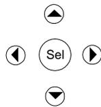
指令功能表現在位於功能控制層級。這是此路徑的最後一層。使用巡覽鍵反白 **OVP Level** (過電壓保護位準) 控制項，如下圖所示。使用數字鍵輸入所需的過電壓位準。接著按下 [**輸入**] 鍵。
