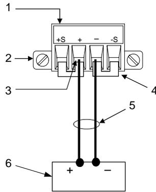
1. 插入電線後用螺絲鎖緊
