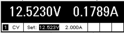
運作模式 (CV = 定電      電壓與電流設定值      遠端介面狀態 (ALL、SRQ、ERR、IO) 壓模式)
