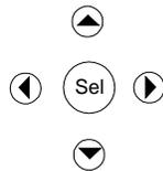
使用向左巡覽鍵與向右巡覽鍵，可以選取您想要變更的設定值。如下圖的顯示幕，已選取通道 1 的電流設定值。使用數字鍵可以輸入數值。接著按下 [輸入] 鍵。
