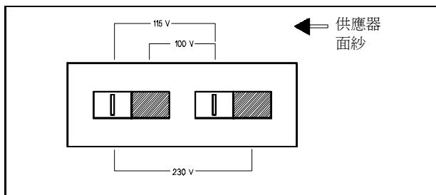
圖 2 線電壓選擇器（針對 115 Vac 設定）
