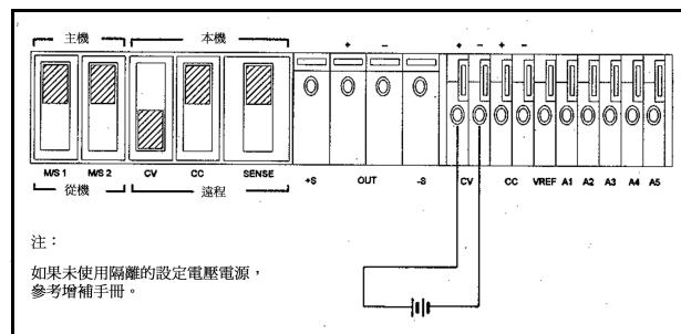
圖 6 遠程電壓設定，定電壓
