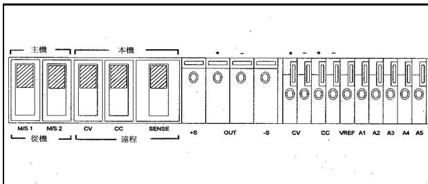
圖 4 開機檢查的背板控制鈕開關設定
