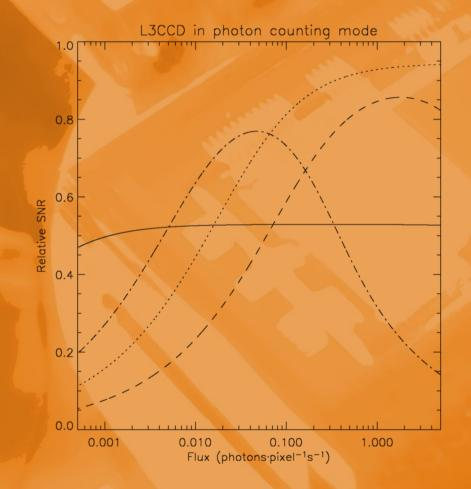
GaAs IPCS, 80 fps, DQE = 28% CCD,  $\sigma$ =3ē, 5min exposures, DQE = 95%, 100kHz readout L3CCD NIMO,  $\sigma$ =30ē, G=3000, 10 fps, DQE = 95%, CIC = 0.003ē·pix·frame L3CCD IMO,  $\sigma$ =30ē, G=3000 0.1 fps, DQE = 95%, CIC = 0.1ē·pix·frame
