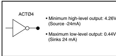
**CW (Signal 3) & CCW (Signal 4) Limit Inputs**
