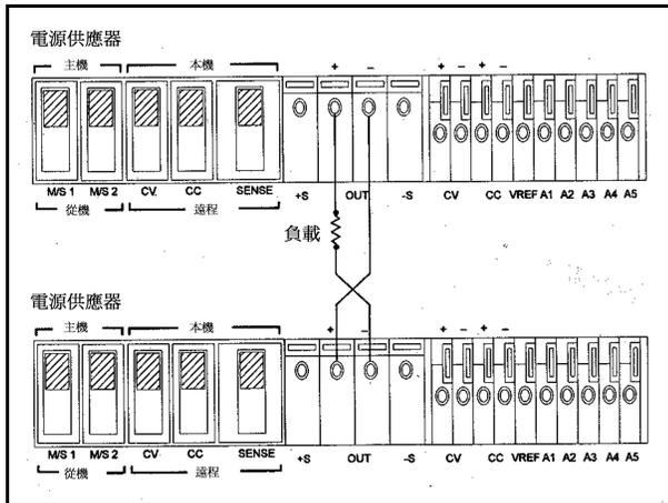
圖 11 一般串聯操作兩個供應器
