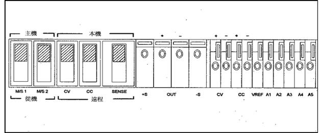
圖 4 開機檢查的背板控制鈕開關設定
