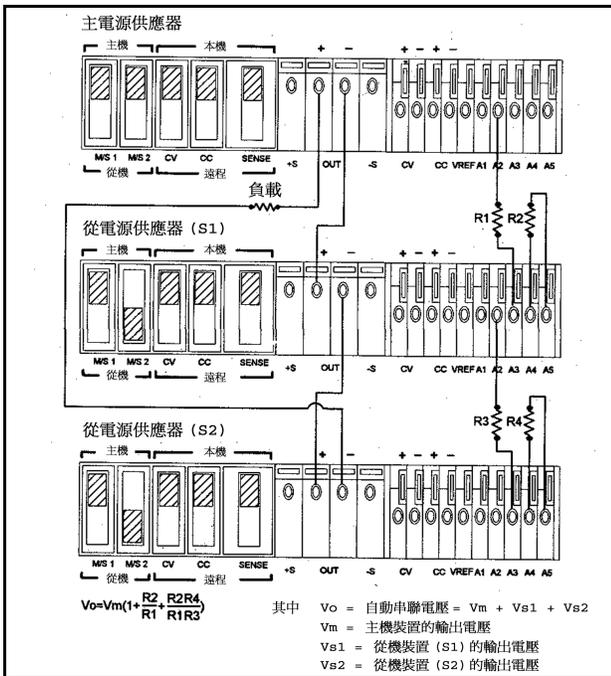
圖 13 自動串聯操作三個供應器
