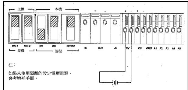
圖 6 遠程電壓設定，定電壓
